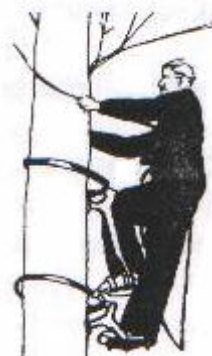
Obrázek 6: Výstup do koruny pomocí výkyvných stupaček Baumwello.
